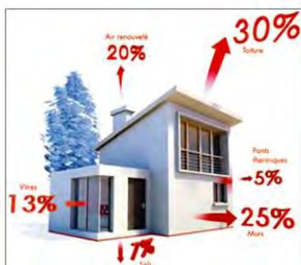
Figure 109 : les sources de déperdition énergétique sur les constructions existantes (source : ADEME)
